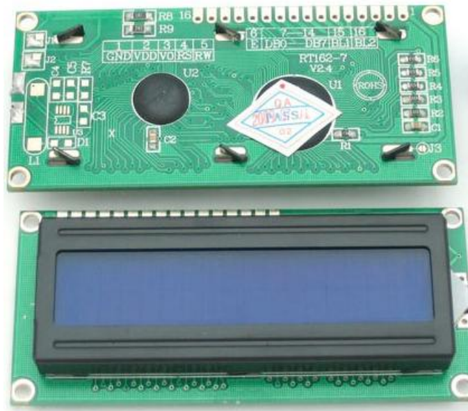
شکل ۱. ساختمان یک LCD کاراکتری
